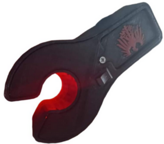
(Fig.1) Localizador de venas realizado en filamento de ácido polilactico por medio de la impresión 3D FDM
